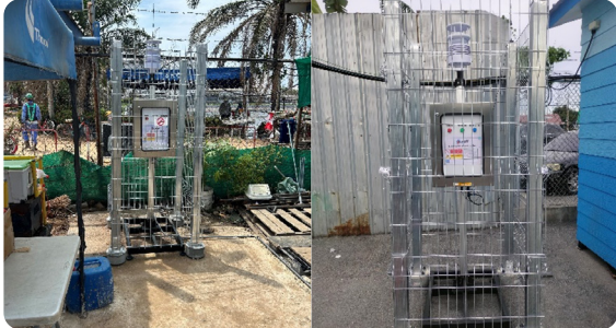
การทดลองติดตั้งเครื่องมือ E-nose บริเวณกลุ่มไทยออยล์
