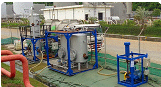
Scrubber Unit Machine ที่พัฒนาเพื่อใช้ลด VOCs ในงานซ่อมบำรุงถังในปี 2566
